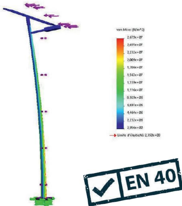
Nos études mécaniques réalisées en amont du projet nous permettent d'adapter les caractéristiques techniques du mât et de son support béton selon la norme EN 40 (support d'éclairage public).
